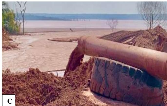
Figura 16: Sistema de transporte da polpa da CT1. A) Zunfu da CT1, B) Estação da CT1, C) Conduto por onde desagua a polpa da CT1 na bacia de retenção de rejeitados (Autora, 2022)
