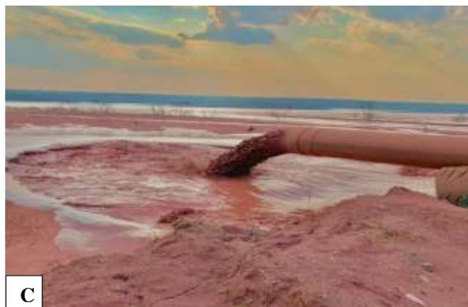
Figura 17: Sistema de transporte da polpa da CT2. A) Zunfu da CT2, B) Estação da CT2, C) Condução por onde desagua a polpa da CT2 na bacia de retenção de rejeitados (Autora, 2022)
